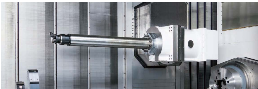
Державка для инструмента АТС (инструмент, установленный к концу оправки посредством АТС)
