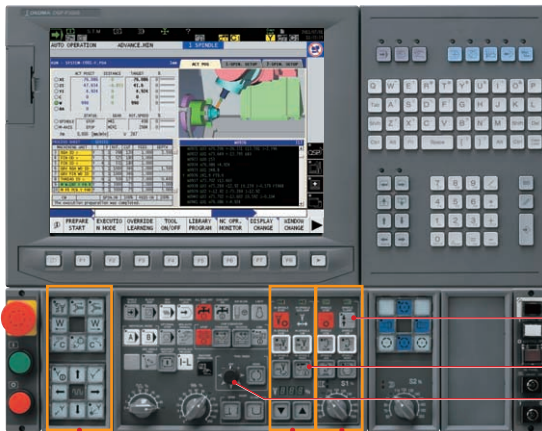
Группа клавиш подачи оси (возможность вкл./выкл. оси С) | Групповые операции M шпинделя | Группа управления шпинделем
