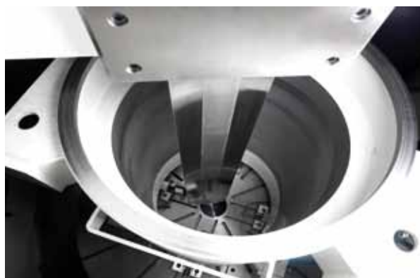
▲ Токарная обработка / растачивание картера двигателя
