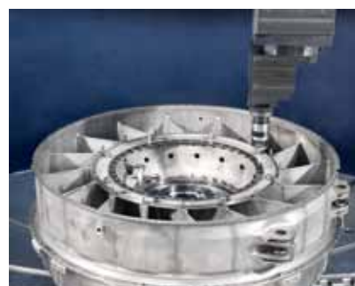
▲ Токарная обработка / шлифовка / измерение компрессоров авиационных двигателей
