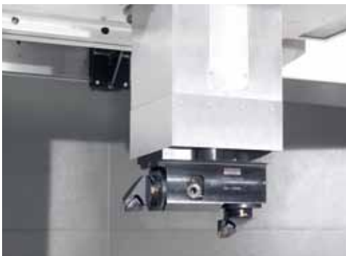
▲ Резцедержатели для инструментов модульной конструкции: Capto, KM...
