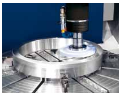
▲ Токарная обработка / сверление / фрезеровка корпусов генераторов
