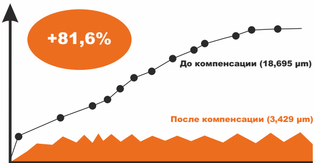
Компенсация тепловой деформации по оси X
